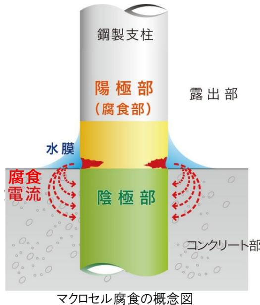
マクロセル腐食の概念図
