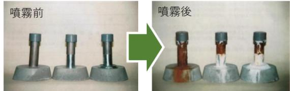
塩水噴霧480時間後、材料を何も施工していない裸試験体は、全面で腐食が発生していたが、メタルガードテープのみの試験体とポールキーパー施工試験体は共に施工範囲である地際部に腐食が見られなかった。
